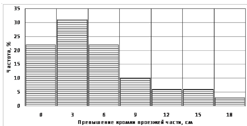
Рис. 3. Превышение кромки проезжей части над обочиной: a – федеральная дорога М-4; б – дорога Волгоград – Астрахань
